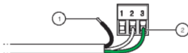
图 3-13 正确的导线制作及插入
