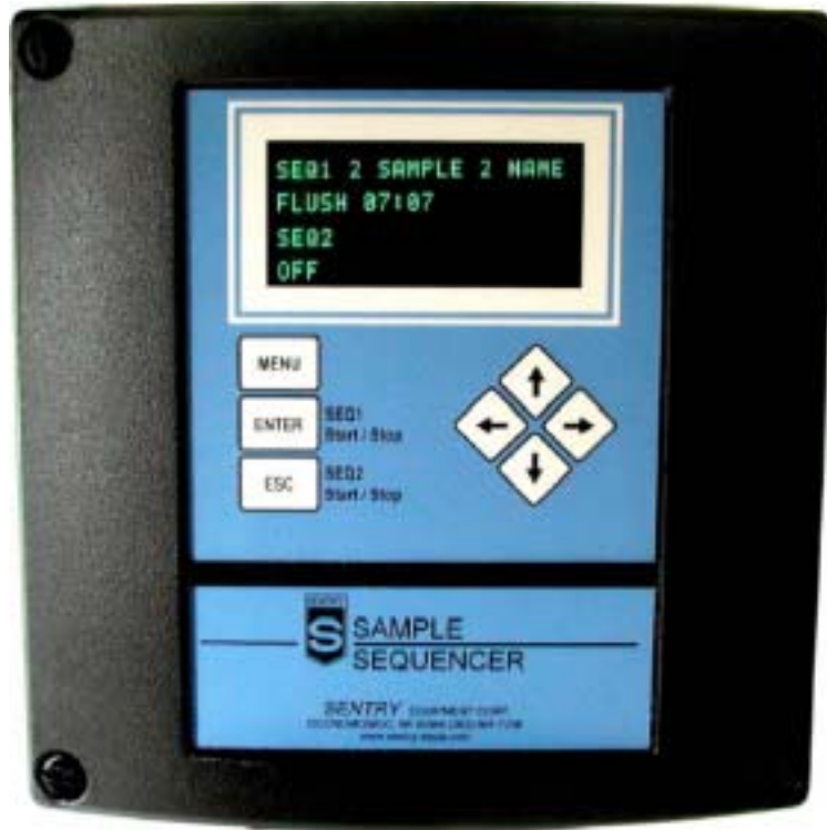
图 4 样品序列发生器前面板
